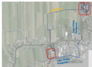
Figuur 1 - Overzichtkaart transportleidingen rond drinkwaterproductielocatie Woerden
